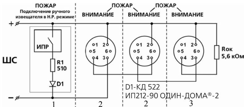
Рис.5. Схема подключения извещателя ОДИН ДОМА®-2 в режиме «Внимание».
